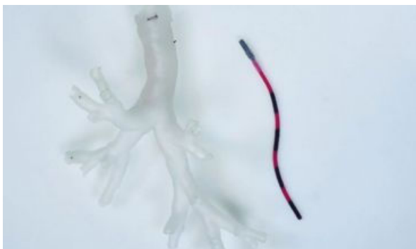
Desarrollan un robot con tentáculo magnético que llega a los bronquios más pequeños de los pulmones
